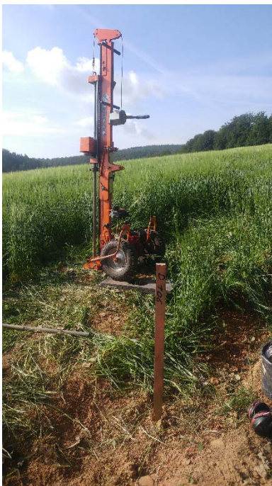
Schwere Rammsondierung DPH
